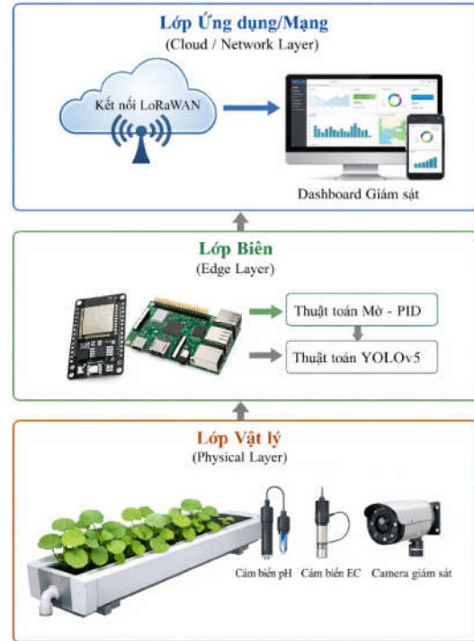
Hình 1: Sơ đồ kiến trúc tổng thể của hệ thống AIoT
