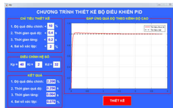
Hình 9. Đáp ứng quá độ của bộ điều khiển PID kênh độ cao khi K_p = 40 , K_i = 2 , K_d = 32
