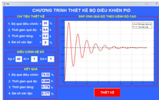
Hình 7. Đáp ứng quá độ của bộ điều khiển PID kênh độ cao khi K_p = 40 , K_i = 1 , K_d = 1
