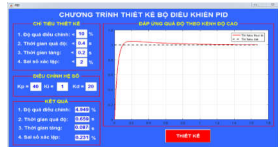
Hình 8. Đáp ứng quá độ của bộ điều khiển PID kênh độ cao khi K_p = 40 , K_i = 1 , K_d = 20
