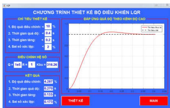
Hình 10. Đáp ứng quá độ của bộ điều khiển LQR kênh độ cao khi HsQ = 10^5 , HsR = 1 , K_{bu} = 316,26
