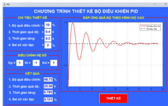
Hình 6. Đáp ứng quá độ của bộ điều khiển PID kênh độ cao khi K_p = 1 , K_i = 1 , K_d = 1
