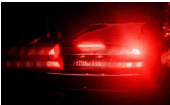
Hình 5. Minh họa hiệu ứng mảng ảo (bóng ma) từ đèn hậu của một chiếc ô tô đang đứng yên
