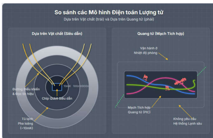
Hình 1: So sánh mô hình điện toán: QC dựa trên vật chất (trái) yêu cầu làm lạnh sâu, trong khi QC quang tử (phải) có thể hoạt động ở nhiệt độ phòng trên chip tích hợp (PIC).
