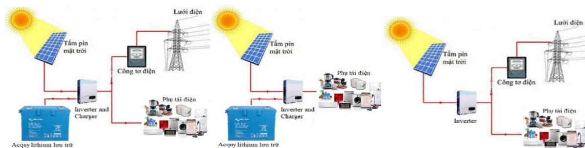
Hình 1. Sơ đồ khối hệ thống đèn LED năng lượng mặt trời: a) độc lập (không có lưới điện); b) song song với lưới điện (Hybrid) có lưu trữ, c. Nối lưới không lưu trữ
