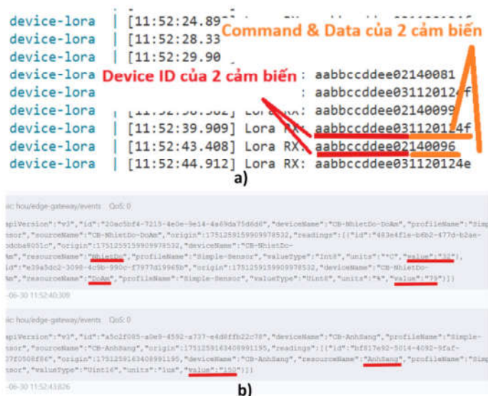
Hình 3. a) Nhật ký của Device Service khi nhận dữ liệu từ các cảm biến. b) Giao diện MQTTX hiển thị dữ liệu cảm biến từ EdgeX gửi tới.
