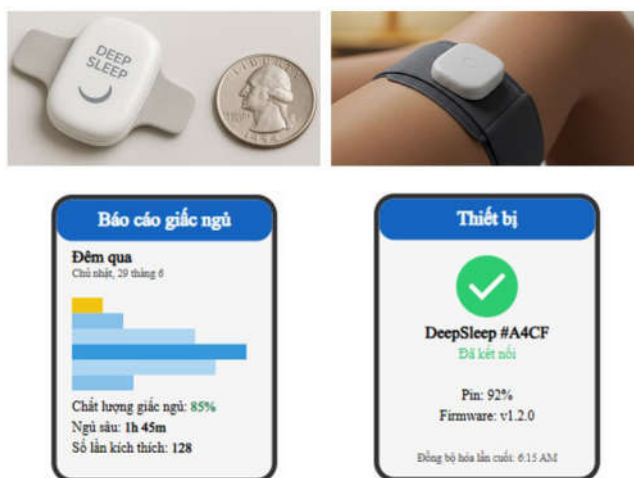
Hình 6: Giao diện ứng dụng di động và nguyên mẫu thiết bị khi sử dụng.
