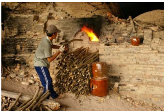
H.6. Lò nung gốm bằng củi, bằng than hoa - nguồn gomnghethuat.com
